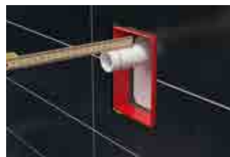
6. Jelölje a menetes hüvelyt a falsíktól 3cm-re!
